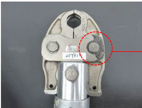
写真1 破損したダイスの外観
