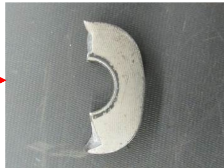
写真2 ダイスの破片
