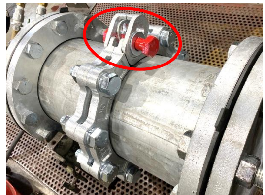
写真 6-17 ボルトを1本締め忘れた場合を想定した試験の外観
