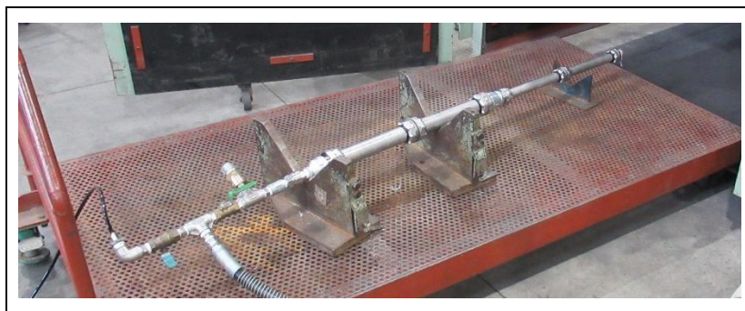
写真 4-6 内圧繰り返し試験状態
