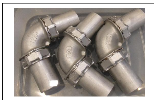
写真 4-8-1 腐食試験状態
