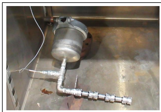
写真 4-9 実体による促進劣化試験状態
