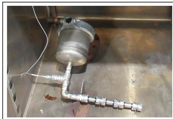
写真 4-9 実体による促進劣化試験
