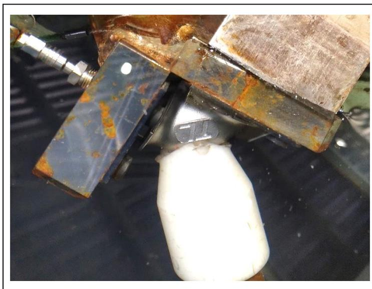
写真 4-1 胴の気密試験
