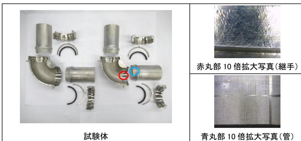
写真 4-8-2 腐食試験結果
