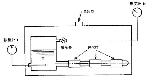
図 4-9 実体による促進劣化試験図
