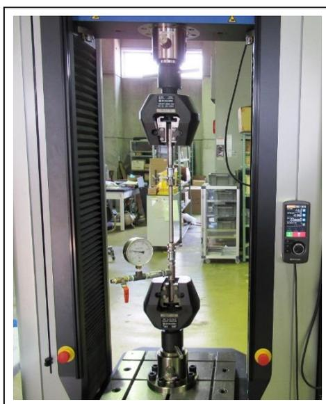
写真 4-4 引抜試験
