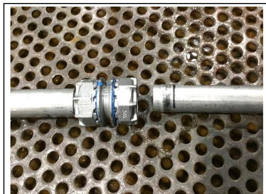
写真 4-12 破壊水圧試験(試験後)
