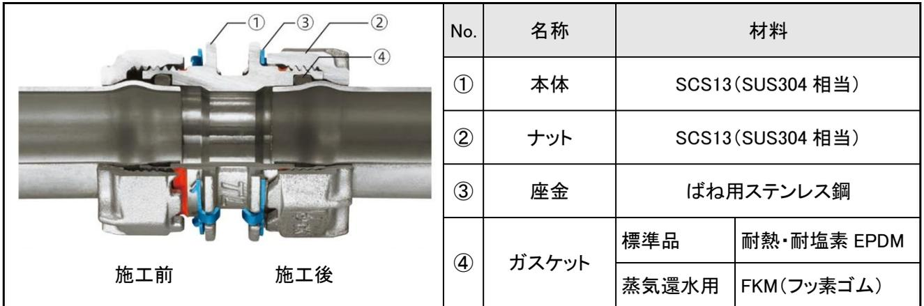
図 2-1 TL ジョイントの基本構造
