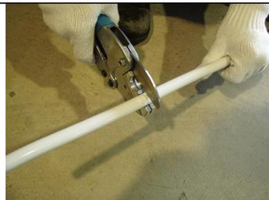
(2)端面仕上器を用いて管端の偏平矯正と面取りを行って下さい。
