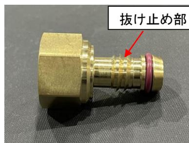
(4)テストプラグを管に挿入し、テストプラグを時計回り(右回り)にねじ込み、管端が必ずテストプラグの当たり面に触れるまで確実にねじ込んで下さい(回転目安:5回転)。
