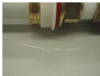
図-4 施工不具合を水圧試験にて発見可能
