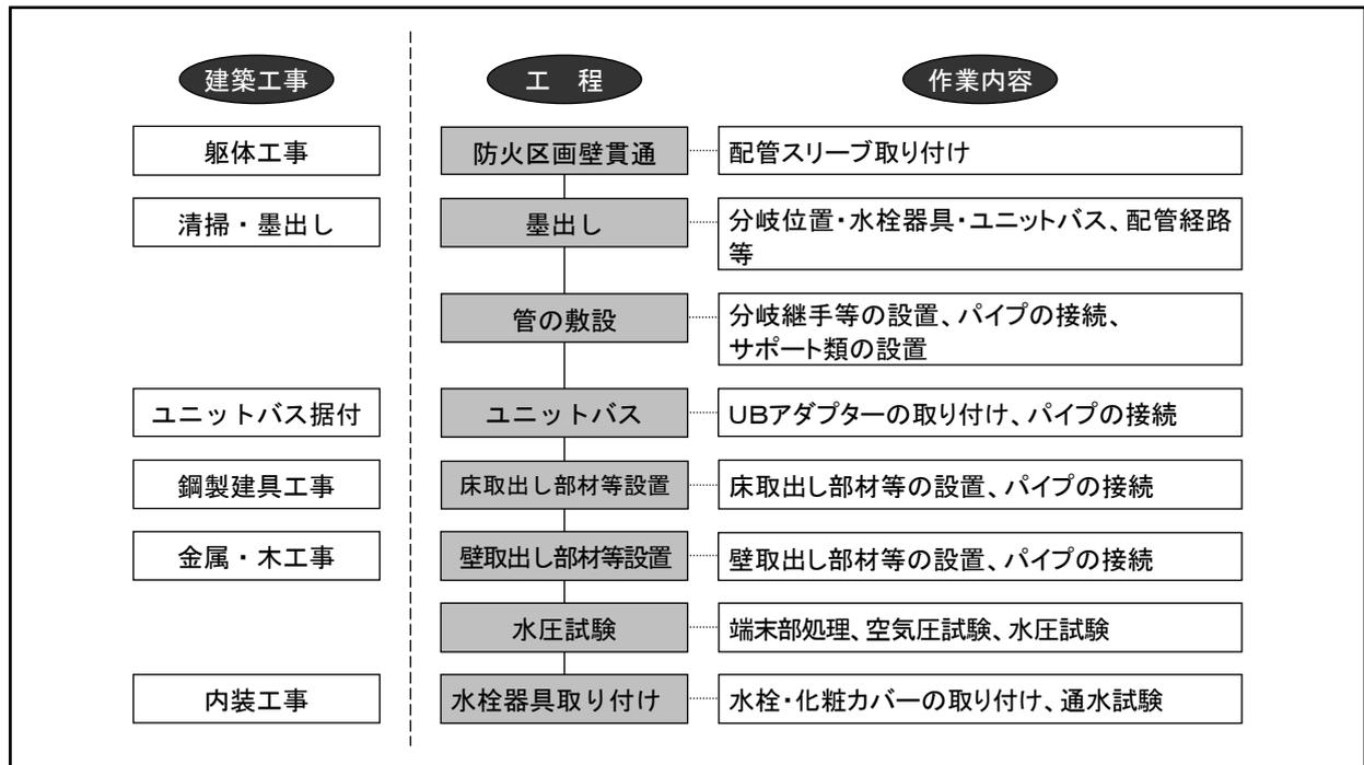
図 5-16 分岐工法施工フローチャート
