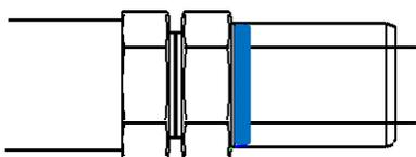
マルチ1クリアの挿入長さ基準
