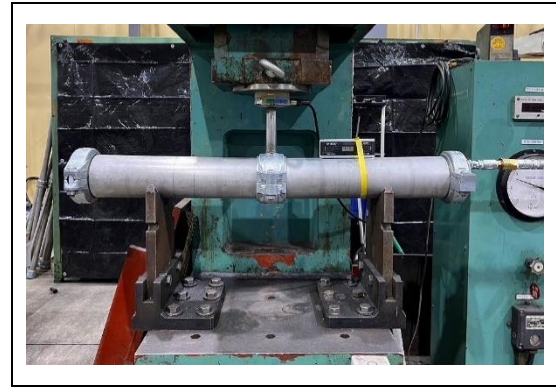
写真 4-9-2 曲げ破壊試験 (ステンレス鋼鋼管転造形)
