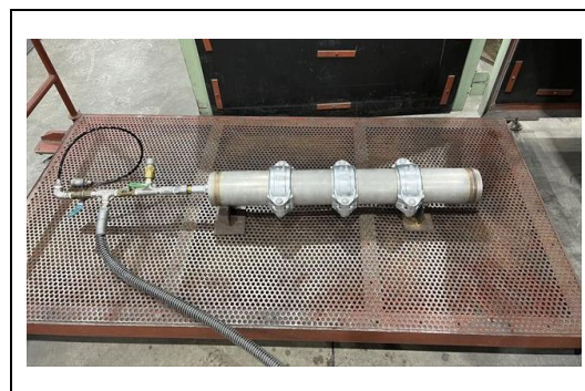
写真 4-7-4 水撃圧試験 (ステンレス鋼管丸リング)
