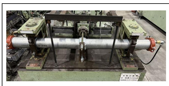
写真 4-14-1 繰返し曲げ試験 (軽量鋼管転造形)
