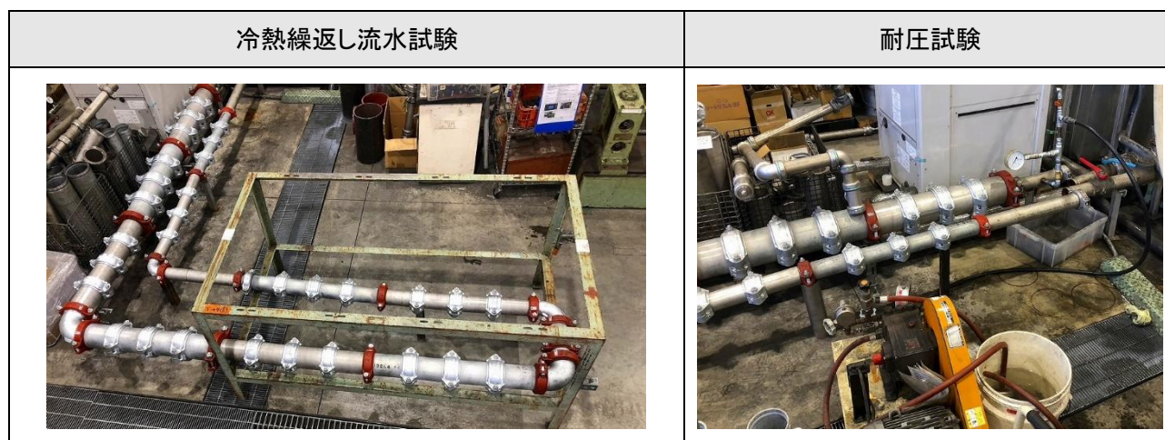
写真 4-5 冷熱繰返し流水試験
