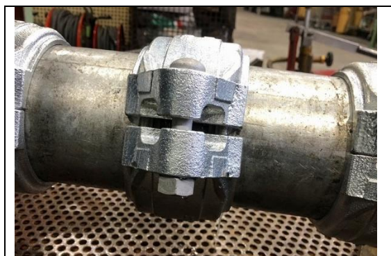
写真 4-16-1 B-0 手締め時の耐圧試験
