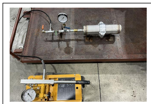
写真 4-8-2 破壊試験 (ステンレス鋼管転造形)
