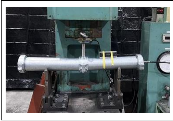
写真 4-9-1 曲げ破壊試験 (軽量鋼管転造形)
