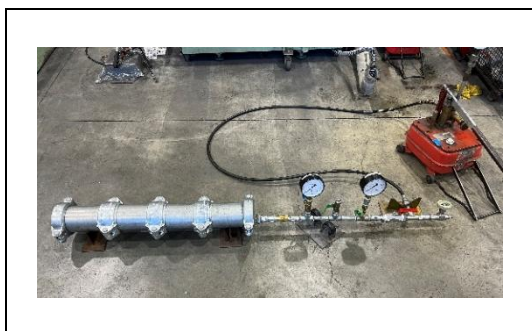
写真 4-1-1 漏れ試験 （軽量鋼管転造形）
