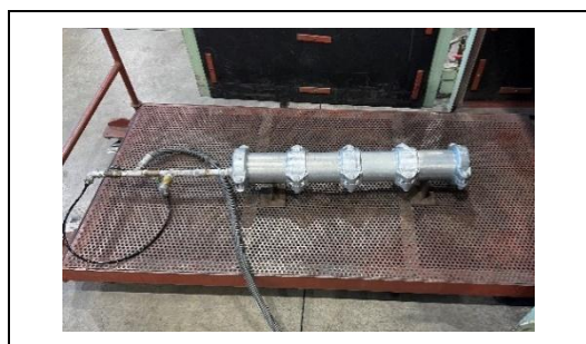
写真 4-4-1 内圧繰返し試験 （軽量鋼管転造形）
