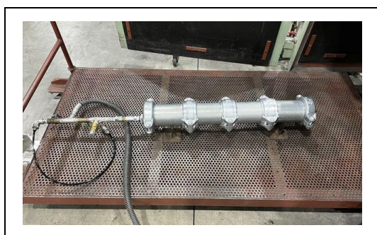
写真 4-7-1 水撃圧試験 (軽量鋼管転造形)
