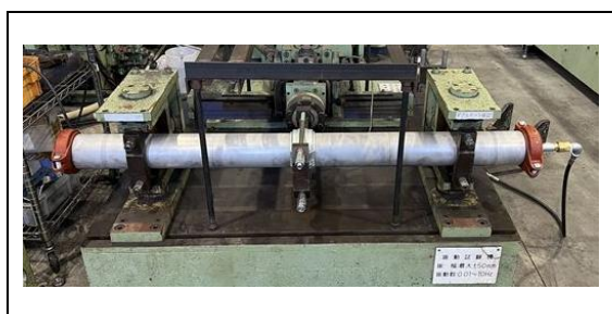
写真 4-14-3 繰返し曲げ試験 (ステンレス鋼管角リング)
