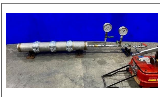
写真 4-1-3 漏れ試験 （ステンレス鋼管角リング）
