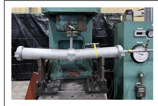
写真 4-9-4 曲げ破壊試験 (ステンレス鋼鋼管丸リング)
