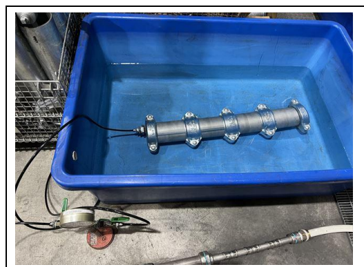
写真 4-6-2 気密試験 (ステンレス鋼鋼管転造形)
