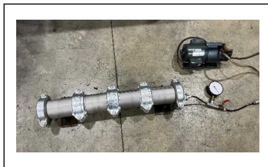
写真 4-3-2 負圧試験 (ステンレス鋼鋼管転造形)
