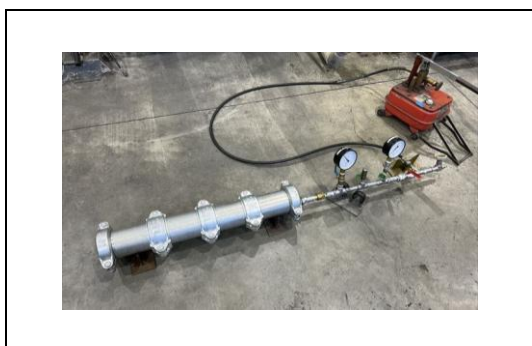
写真 4-2-1 耐圧試験 (軽量鋼管転造形)
