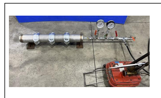
写真 4-1-4 漏れ試験 （ステンレス鋼管丸リング）
