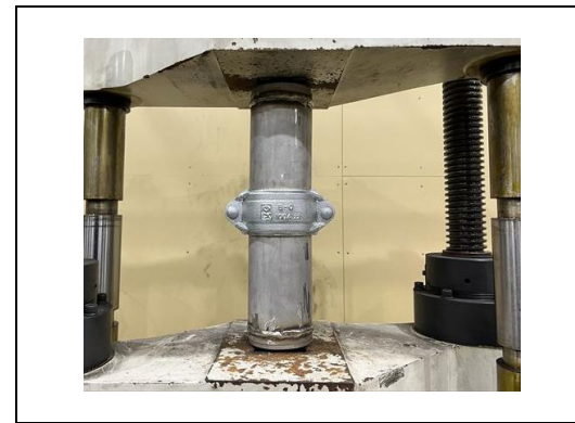
写真 4-10-4 引張強度試験 (ステンレス鋼鋼管丸リング)
