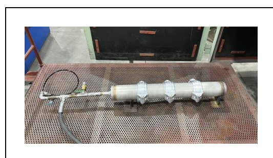
写真 4-4-4 内圧繰返し試験 （ステンレス鋼管丸リング）
