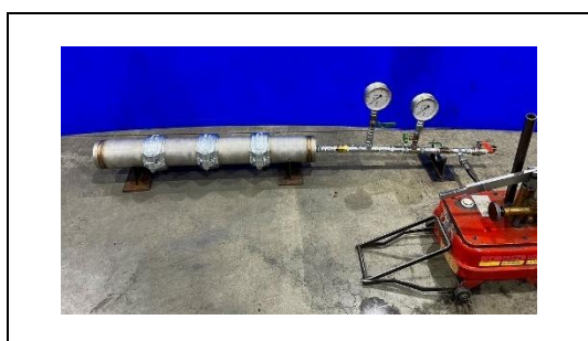
写真 4-2-3 耐圧試験 (ステンレス鋼管角リング)
