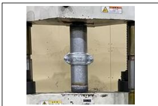
写真 4-10-1 引張強度試験 (軽量鋼管転造形)
