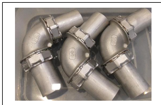
写真 4-8-1 腐食試験状態
