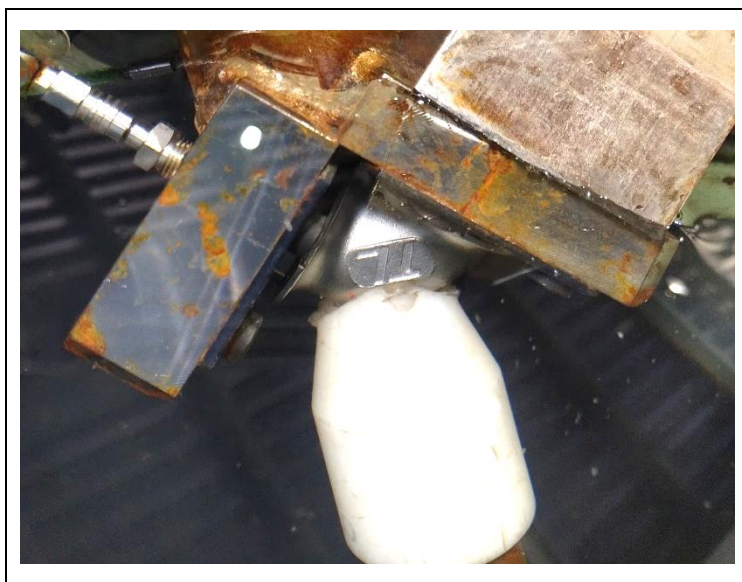
写真 4-1 胴の気密試験状態
