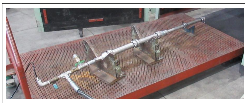
写真 4-6 内圧繰り返し試験状態
