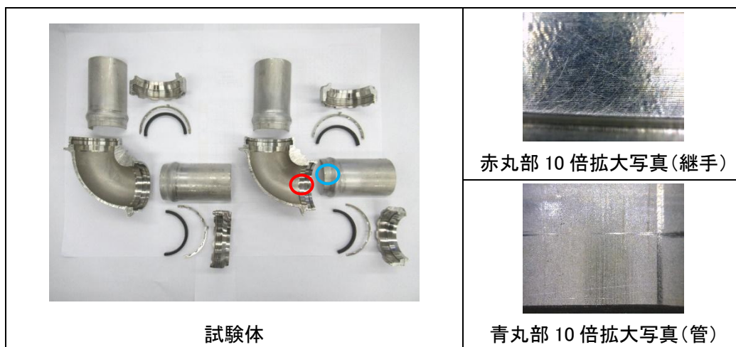
写真 4-8-2 腐食試験結果
