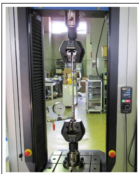
写真 4-4 引抜試験状態
