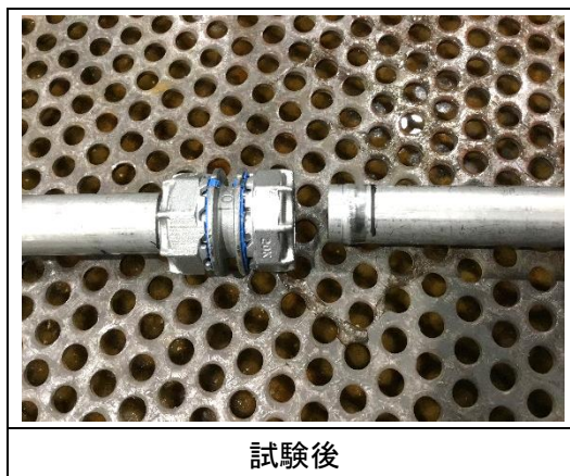
写真 4-13 破壊水圧試験状態
