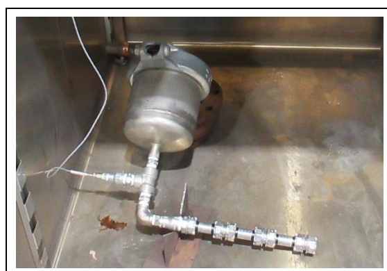
写真 4-9 実体による促進劣化試験状態
