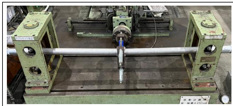
写真 4-21-1 耐震試験(震度 7 相当、加速度 947Gal)状態
