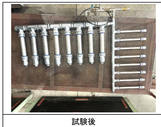
写真 4-19 内圧繰り返し試験状態
