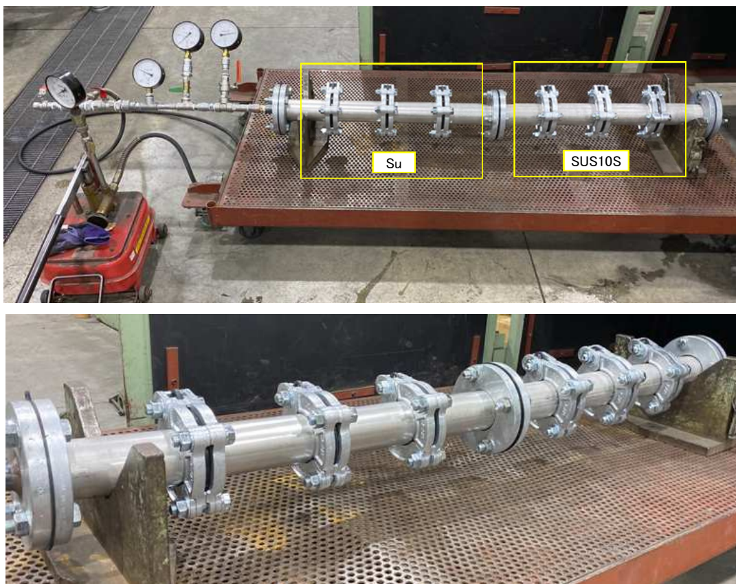
写真 6-1-2 耐圧試験外観
