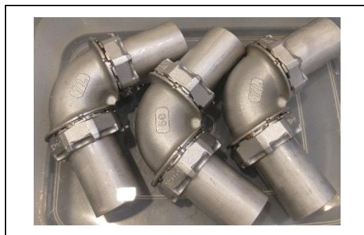
写真 4-8-1 腐食試験(試験中)
