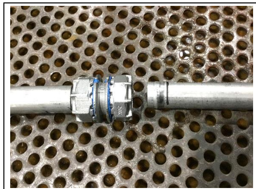
写真 4-12 破壊水圧試験(試験後)
