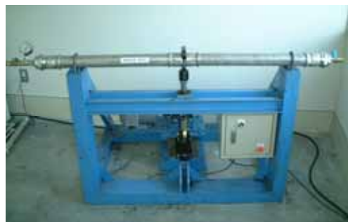
写真4.1 振動試験装置
