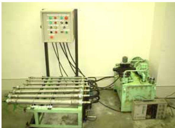
写真4.2 内圧繰返し試験の外観
